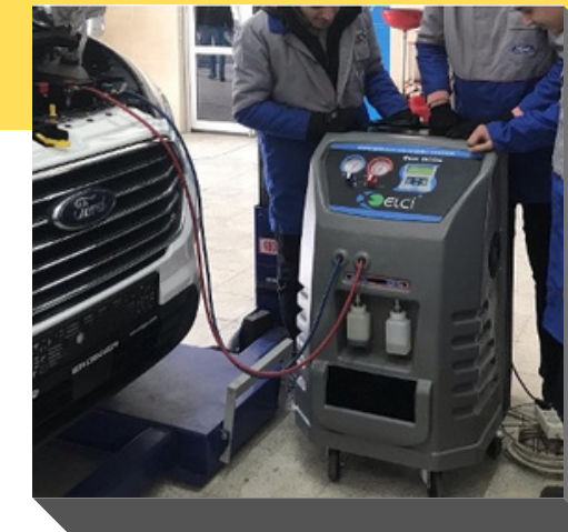
KLİMA GAZ DOLUMU
